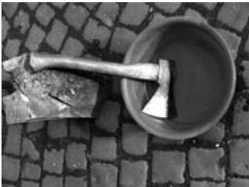
Schleifen würde in diesem Fall den umgebogenen Teil entfernen und es müßte die Schneide sehr stark nachgeschliffen werden, um die Scharte wieder zu entfernen.
