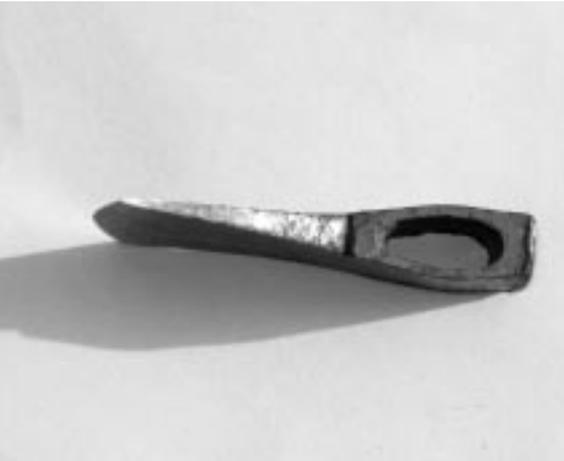
nicht durch- bzw. wegzuschleifen. Geschieht dies, so ist die Schneide nach den ersten Schlägen wieder stumpf. Das Beil muß dann in einer Esse wieder erhitzt, abgeschreckt und wieder „angelassen“ werden – das ist etwas für Schmiede und lohnt sich nur hochwertigen Äxten und Beilen. Das Schleifen selbst geschieht in mehreren Schritten. Das regelmäßige Abziehen mit einem feinen Wetzstein (naß) oder –stahl erhält die Schärfe, aber bitte auch hier
