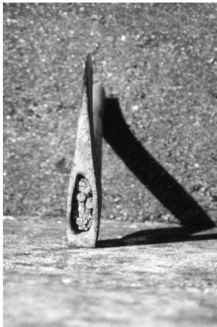
Da die Beile verschieden schwer sind, gibt es dem entsprechend unterschiedliche Stiele, hinzu kommt, das die Stielaufnahme unterschiedliche Formen aufweisen kann; also am besten den Beil- / Axtkopf beim Stielkauf mitnehmen. Wer aber glaubt, das nun mit „Stiel reinstecken und Keil reinklopfen“ die Reparatur erledigt ist, wird in 99% der Fälle enttäuscht.
