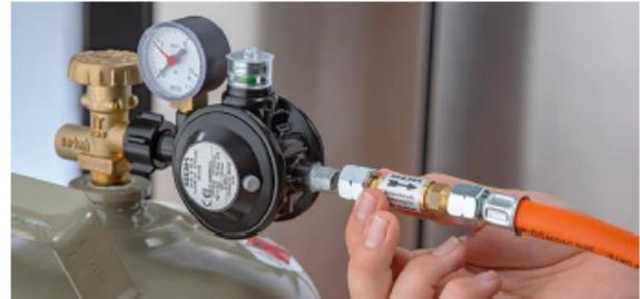
Die Schlauchbruchsicherung „SBS“ ist eine Sicherheitseinrichtung in Flüssiggasanlagen, die vor unkontrolliertem Gasaustritt schützt, sollte es mal zu einem massiven Leck an einer Schlauchleitung kommen.
